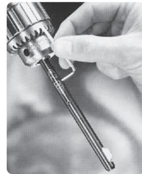
イーザーの面取りの大きさ（面取量）はブレードの調整で決まります。面取量の調整は、イーザーをチャックに取付けたままでできます。ブレードの出入りを調整することで、面取りの大きさを調整。その調整スクリューは、シャンク横（上図）の六角スクリューです。
