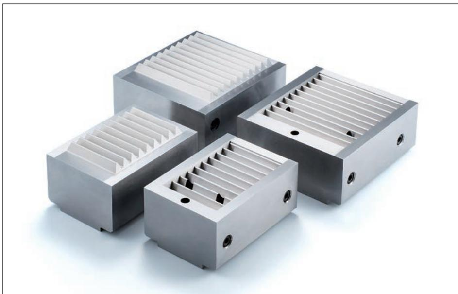
長年の実績を持つアルミダイカスト用ガス抜き部品で、密閉されたダイカスト金型内部より製品内部のガス巻き込みを防ぎ、鑄巣を低減し表面仕上がりも向上します。総研磨にて全て製作しており、真空性能を向上しております。
