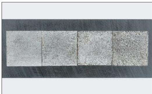
アーク放電により電極材をワーク表面に移行・堆積させるコーティング技術です。耐磨耗、耐熱、耐食、耐酸化性などニーズに合わせた処理が可能です。
